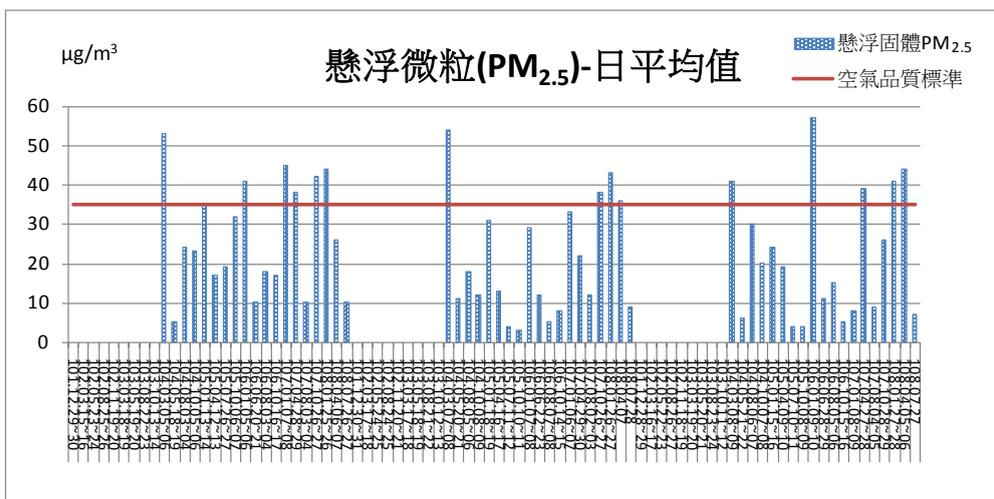
圖 2.1-15 PM<sub>2.5</sub>各測點日平均監測結果比較圖
