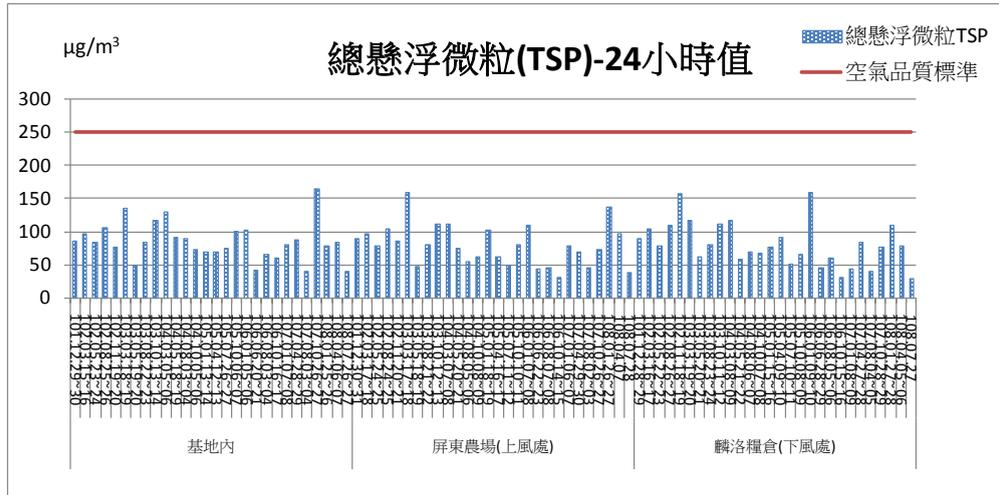
圖 2.1-1 TSP 各測點 24 小時監測結果比較圖
