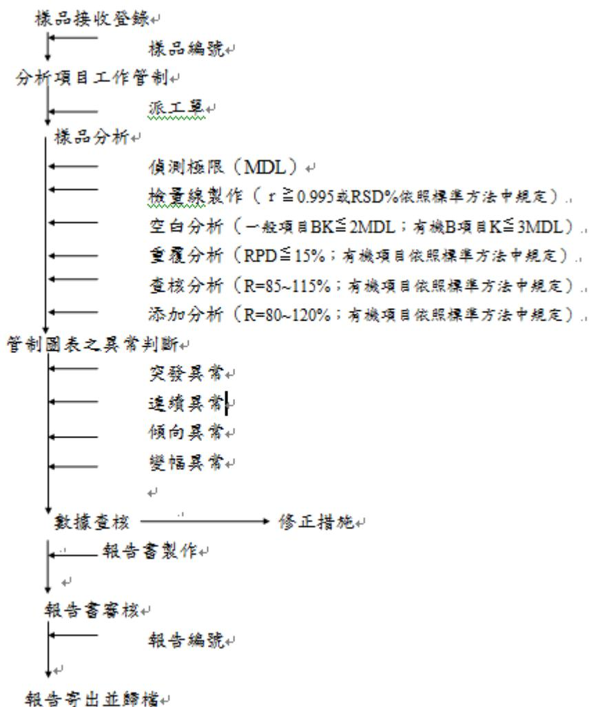
圖 1.4-3 水質之品保 / 品管作業流程圖
