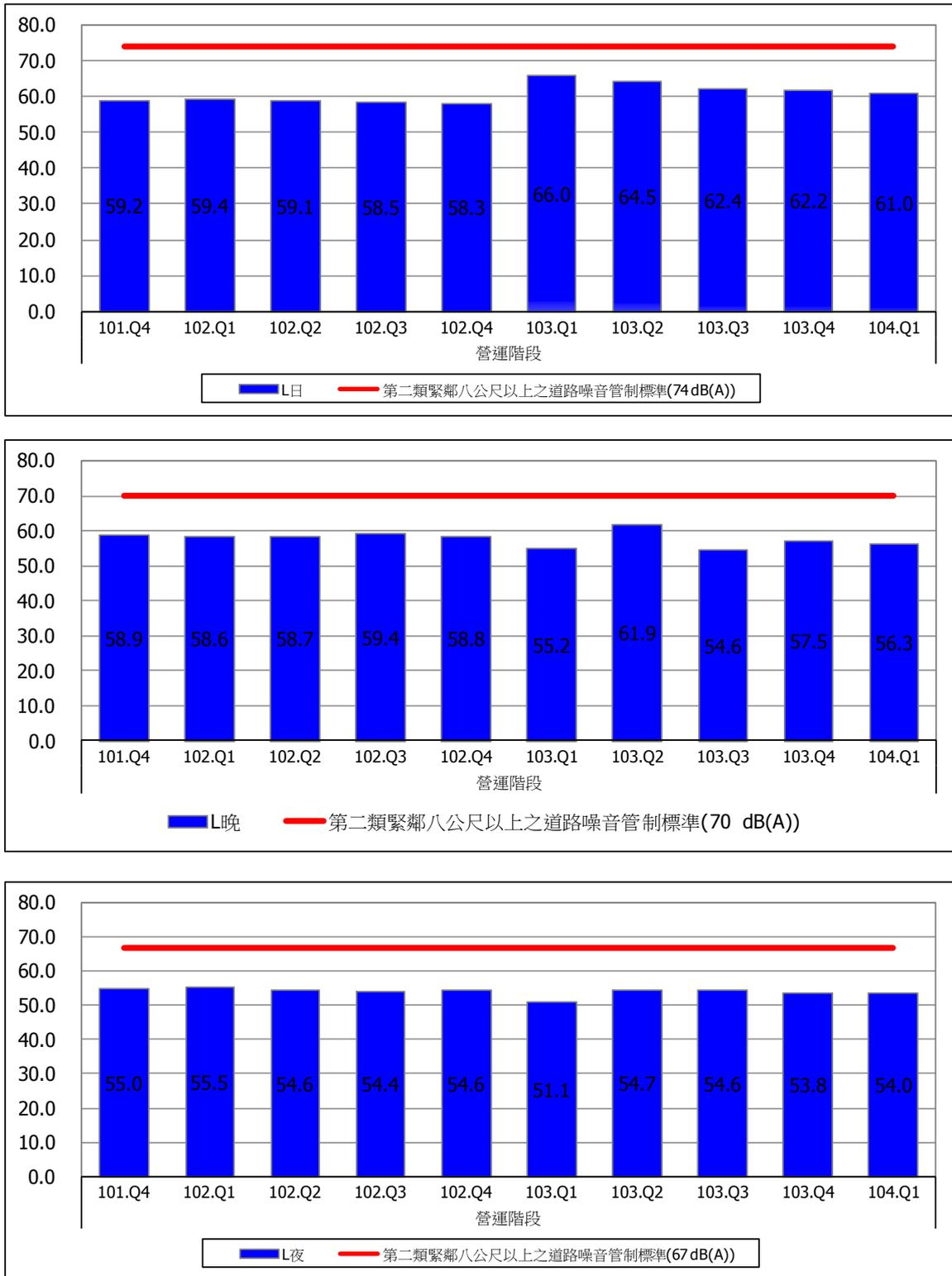
圖 2.2-1 基地出入口噪音監測結果比較圖
