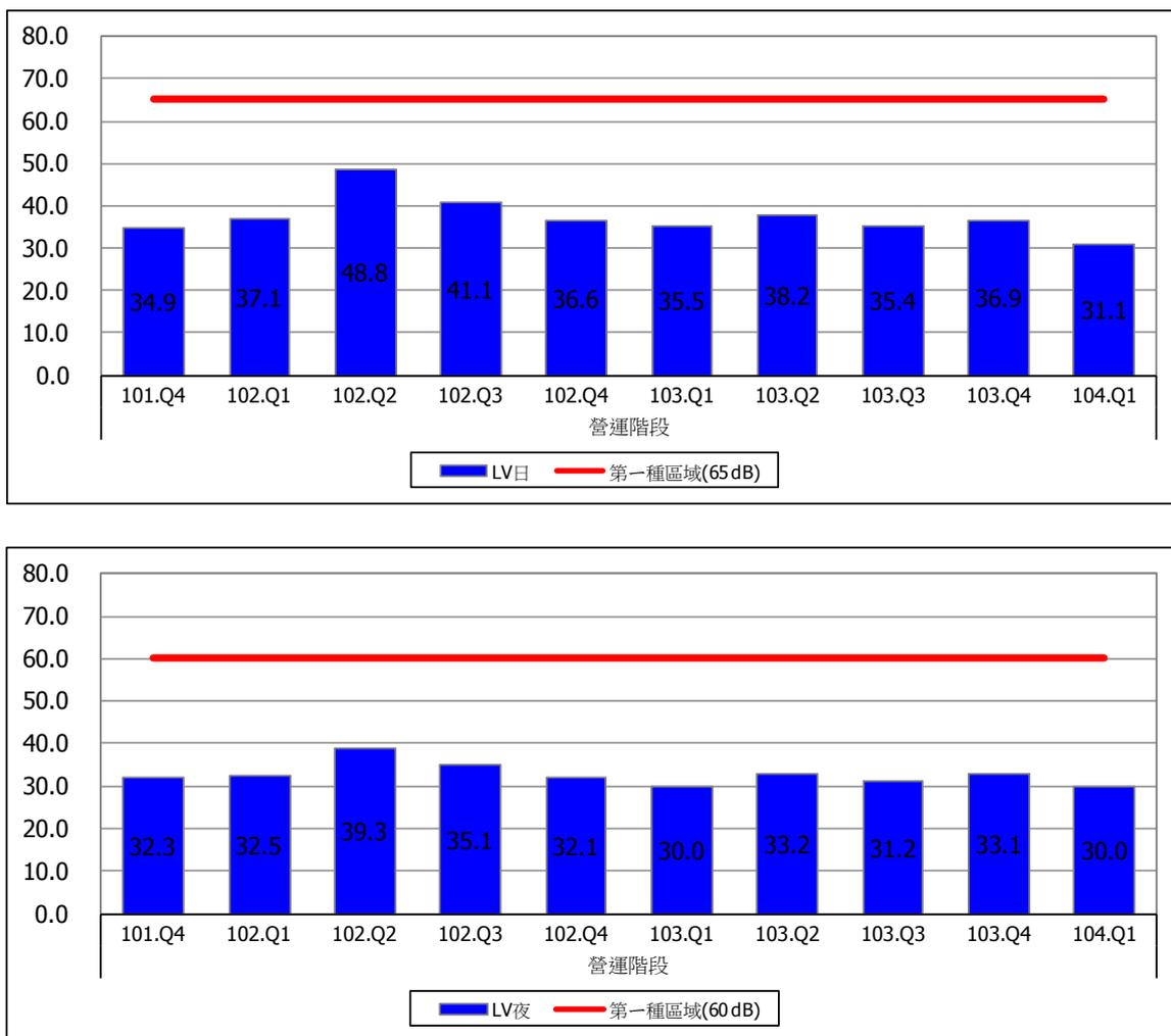
圖 2.2-3 基地出入口振動監測結果比較圖
